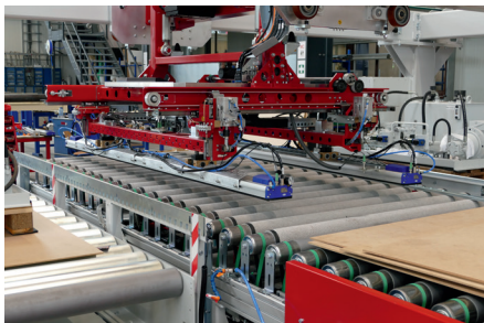
Beschickungsportal mit Saugertooling für die Zuführung einer Kaschieranlage in der Möbelindustrie
