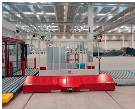
Schienengeführter Querförderwagen zum Stapeltransport in der Möbelindustrie
