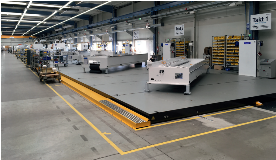
Schienenbasierte Taktmontagelinie im Werkzeugmaschinenbau
