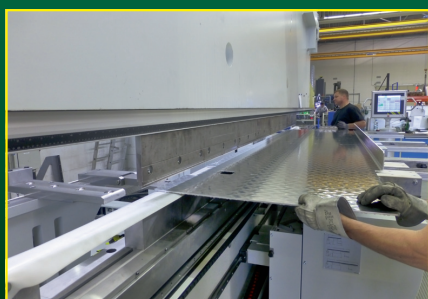
Abkantpresse 1.000 t Presskraft, bis 8 m Länge
