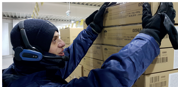
Dank Pick-by-Voice haben die Mitarbeiter in der Kommissionierung immer beide Hände frei – Arbeitsanweisungen zu Artikeln und Stückzahlen erfolgen via Headset.
