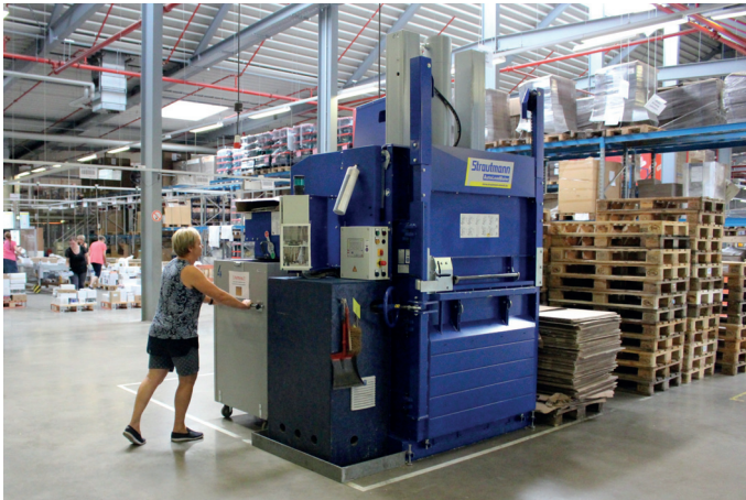
Einschub des Sammelwagens in den AutoLoadBaler
