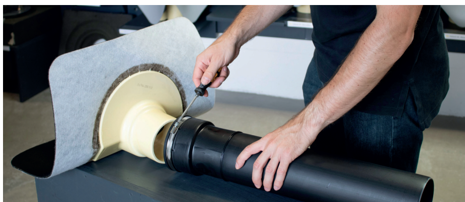
DIE UMLAUFENDE SCHLAUCHSCHELLE AUS EDELSTAHL SICHERT DIE VERBINDUNG VON GULLY UND PE-ROHR.
