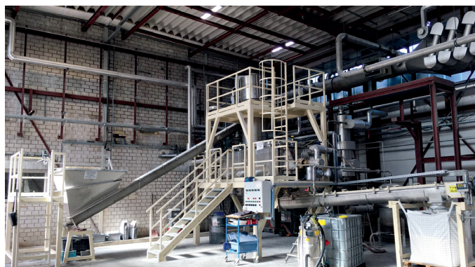
Innovatives Recycling: Mit dem Paddelverdampfer entstehen aus dem Abfallstoff Tonerde zwei neue Produkte.
