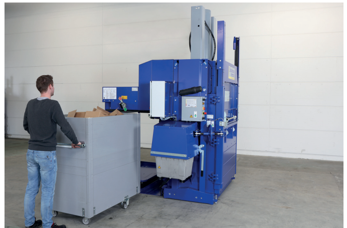
EINSCHUB SAMMELWAGEN IN DEN AUTOLOADBALER (FOTOS: STRAUTMANN UMWELTECHNIK GMBH)
