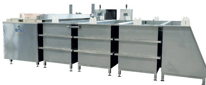
Neues Service-Angebot der Wilhelm Modersohn GmbH & Co. KG, Elektropolieren von Edelstahlbauteilen.
