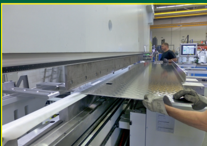
Abkantpresse 1.000 t Presskraft, bis 8 m Länge
