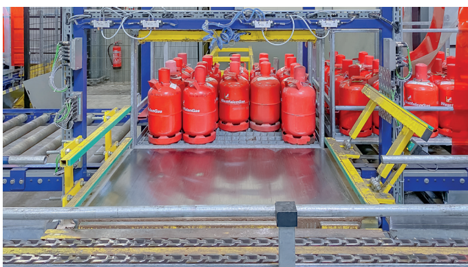
Bild 2: Abschieben der leeren Gasflaschen aus den Transport-Gitterboxen.
