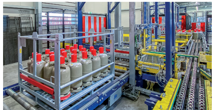
Bild 1: Platzsparendes Anlagenlayout für den Kreislauf der Einschleusung, Entladung, Befüllung, Beladung und abschließender Ausschleusung.
