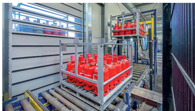
Gitterboxen mit dem Vertikalförderer einfach und zuverlässig übereinander stapeln.
