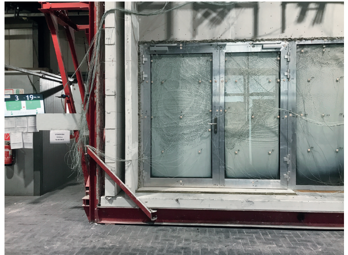
Mit dem Start der Prüfung und der Temperierung des Ofens beginnen die Brandschutzgläser zu reagieren.
