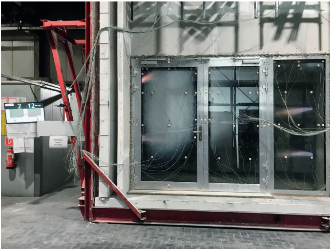
Mit dem Start der Prüfung und der Temperierung des Ofens beginnen die Brandschutzgläser zu reagieren.
