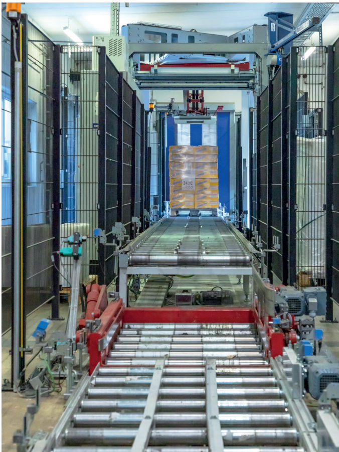
Angetriebene Rollenbahnen für den automatisieren Palettentransport
