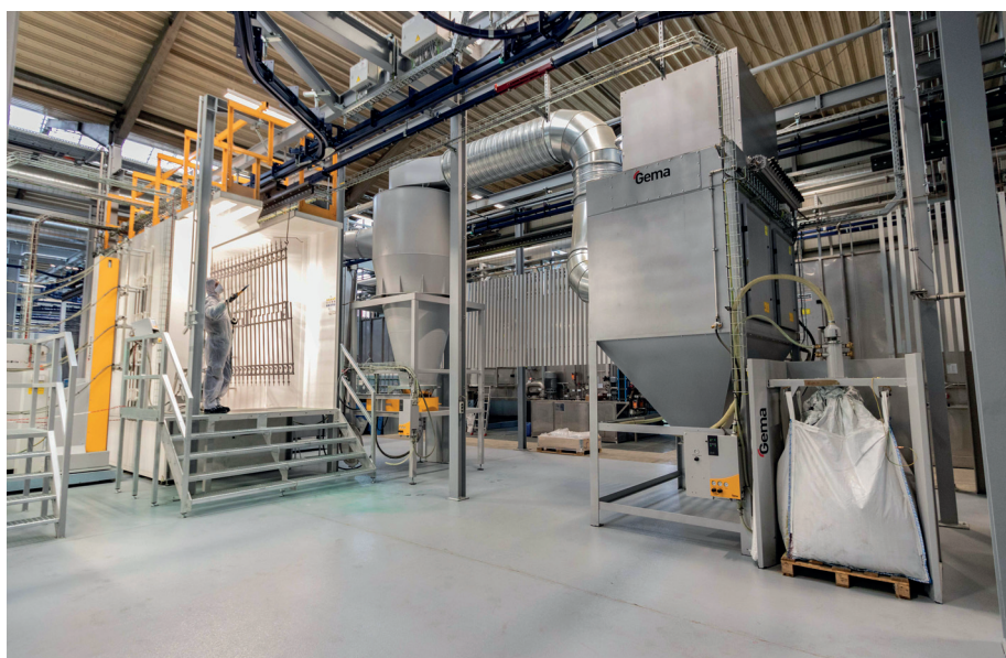
Bauteile werden automatisiert- oder alternativ in einer Handpulverkabine durch entsprechend qualifizierte Mitarbeiter beschichtet.
