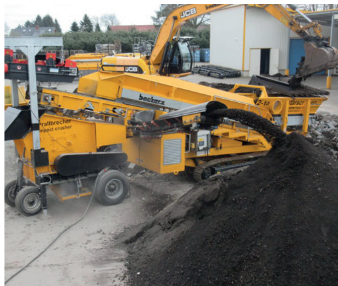
MIT DEM GRIZZLYSCREEN, STERNSIEB UND PRALLBRECHER DER FIRMA BACKERS IST DIE AUFBEREITUNG VON VERSCHIEDENEN MATERIALIEN MÖGLICH.
