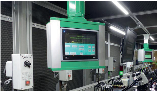
Das Leichtsteuergehäuse CC-4000 von der BERNSTEIN AG in einer selbst entwickelten Produktionslinie der Firma Lumberg.
