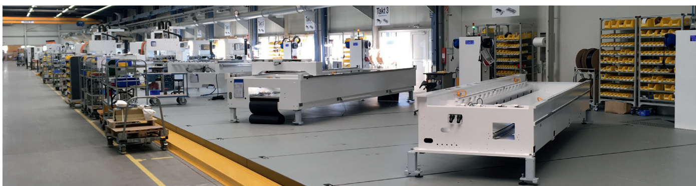
Schienenbasierte Taktmontagelinie im Werkzeugmaschinenbau
