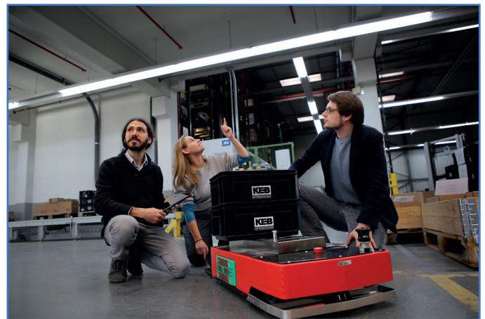
Die Navigation des Transportsystems erfolgt über die Deckenbeleuchtung. Dr. Alexandre Bousaid, Bianca Miene (beide OSRAM) und Tommy Falkowski (Fraunhofer IEM) diskutieren die Technologie.
