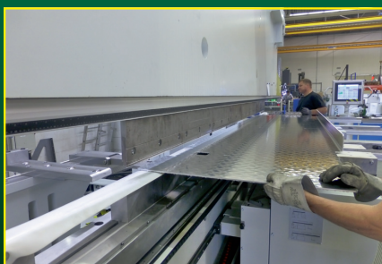
Abkantpresse 1.000 t Presskraft, bis 8 m Länge
