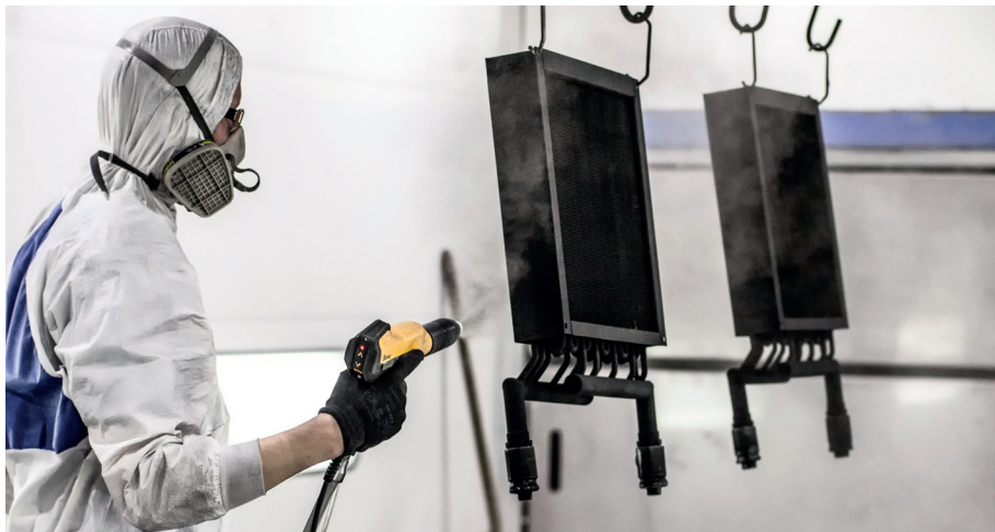
Mit der Pulverbeschichtung bietet Helling & Neuhaus einen echten Mehrwert für die Veredelung von Stahlteilen.
